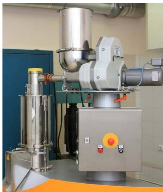
Рис. 1. Пресс-гранулятор Amandus Kahl, тип 14-175
