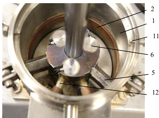
Рис. 2. Установка датчиков силы: 1 – нижняя часть камеры прессования; 2 – кольцевая опора; 3 – прямоугольный вырез в опорном цилиндре; 4 – измерительный стол; 5 – опорные ребра измерительного стола; 6 – датчик силы; 7 – канал для охлаждающей жидкости; 8 – опорная плита; 9 – матрица; 10 – зазор; 11 – стопор; 12 – штуцер
