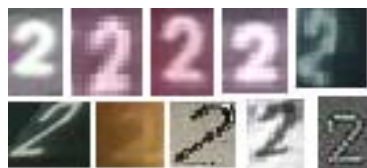
Рис. 5. Изображения обучающей выборки для сверточной нейронной сети. 1 ряд – изображения одного типа маркировки с разным освещением и с различных ракурсов; 2 ряд – изображения разных типов маркировки
