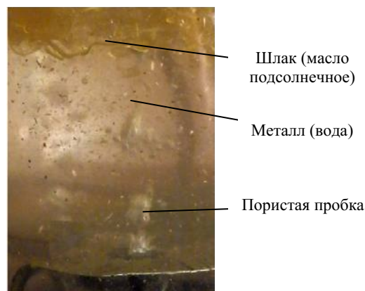
Рис. 1. Внешний вид системы «металл – шлак – включения» при продувке воздухом через пористую пробку
