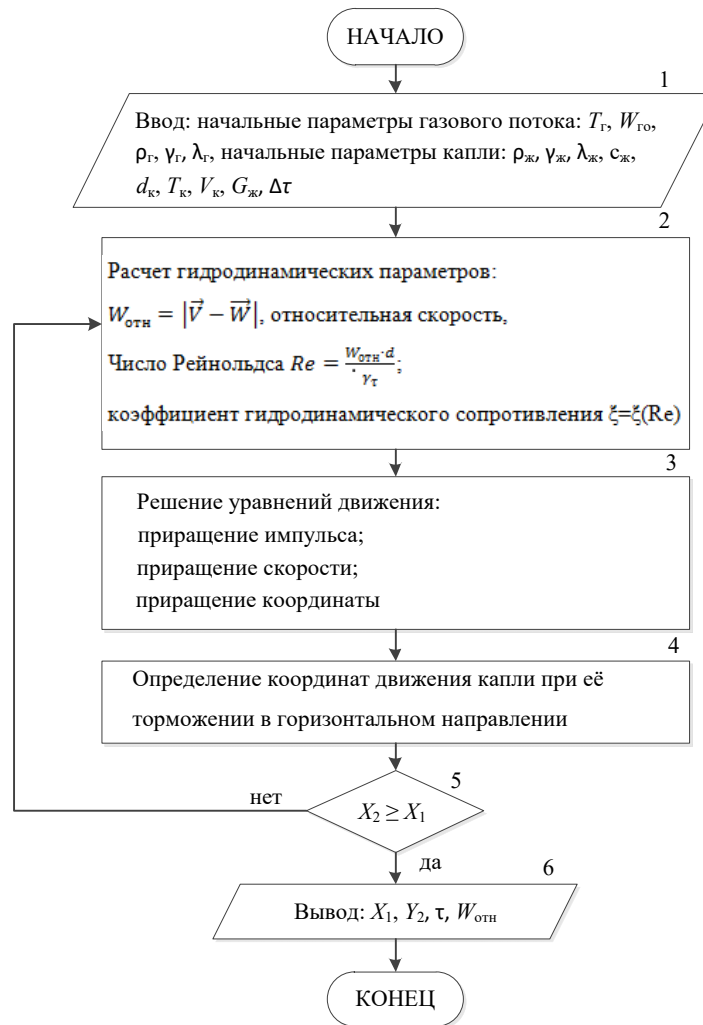
Рис. 3. Алгоритм расчета траекторий движения жидкой капли доменного шлака и оценка траектории движения
