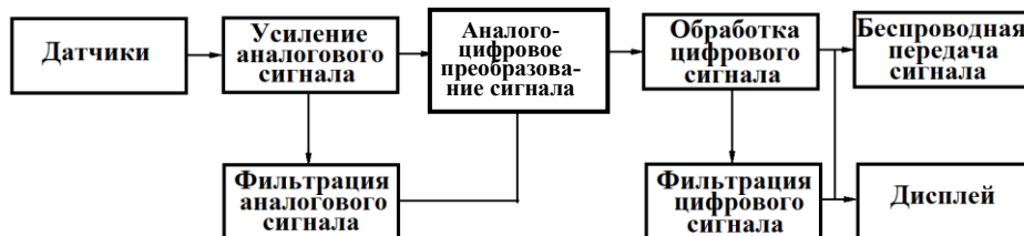
Рис. 2. Стандартная блок-схема необходимой контрольно-измерительной аппаратуры для получения биомедицинских сигналов
