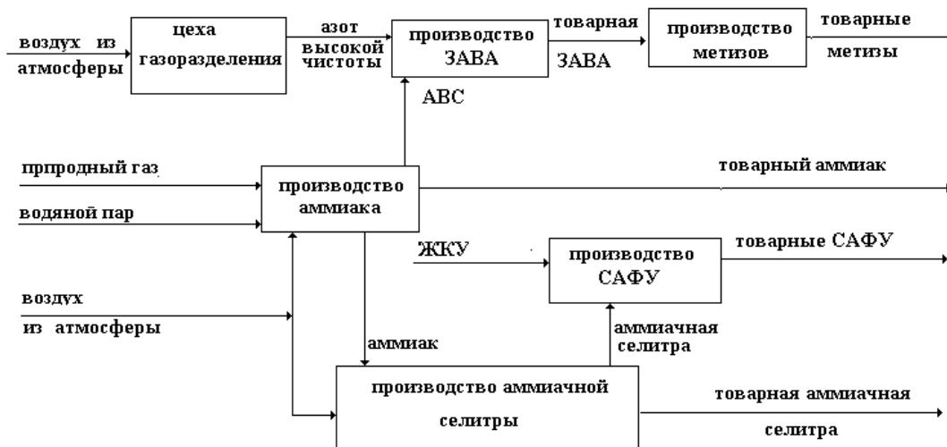
Рис. 1. Объединенный граф производства товарных азота, ЗАВА, аммиака, аммиачной селитры и САФУ на Череповецком производственном комплексе
