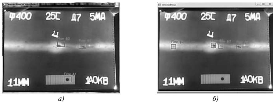
Рис. 8. Результаты обработки изображений классификаторами Хаара: а – первоначальным классификатором, основанным на ~ 600 образцах; б – классификатором, основанным на ~ 16000 образцах
