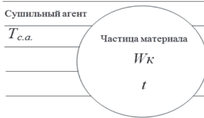
Рис. 1. Схема к математической модели тепломассопереноса
