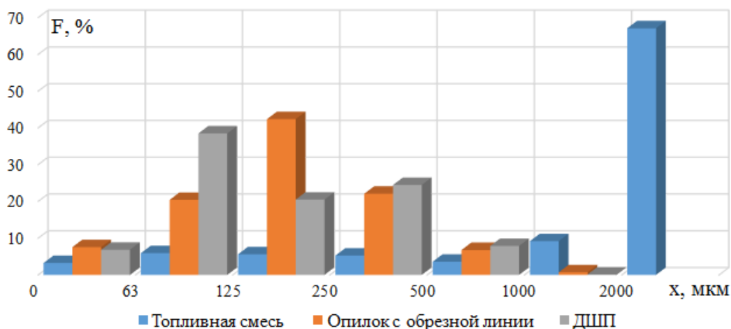
Рис. 1. Фракционные остатки, характеризующие гранулометрический состав топливной смеси и двух ее взрывоопасных компонентов
