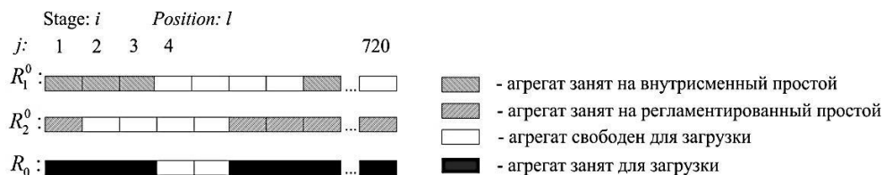
Рис. 2. Графическое изображение матроидных матриц для внутрисменных простоев, регламентированных простоев и свободного времени оборудования
