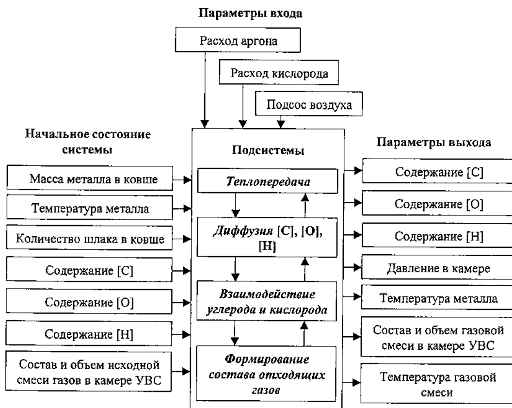
Рис. 1. Структурная схема системы процесса вакуумной обработки
