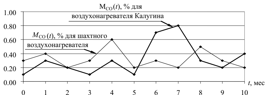
Рис. 1. Замеры содержания CO в дымовых газах
