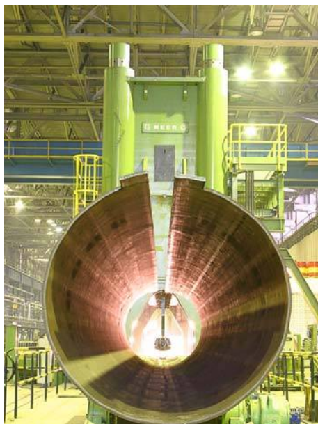
Рис. 3. Трубоформовочный пресс “SMS Meer”
