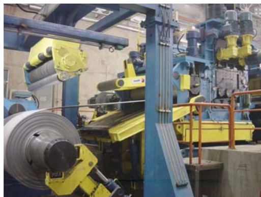
Рис. 5. Листоправильная машина “Fagor Arrasate”
